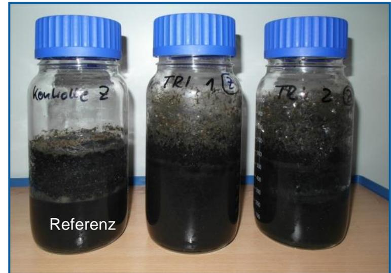
Gärmaterial aus einer NawaRo-Anlage: mit 2 % (w/w) Triticale und ohne Substrat (Referenz)
